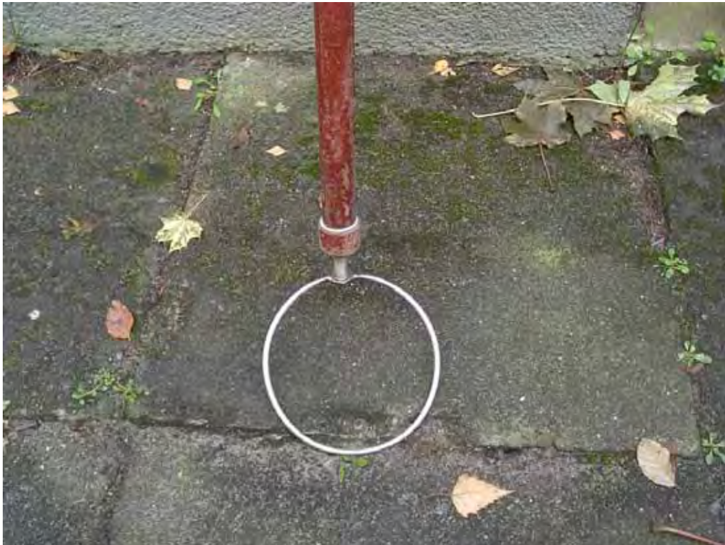
Bild 7.3-3 Ringanode mit einem Durchmesser von 15 cm
