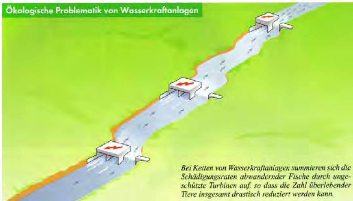
Bild 10.2.2.4-1: Summierung der Schädigungsraten abwandernder Fische durch Kraftwerksketten in Fließgewässern (aus: MUNLV [2001])
