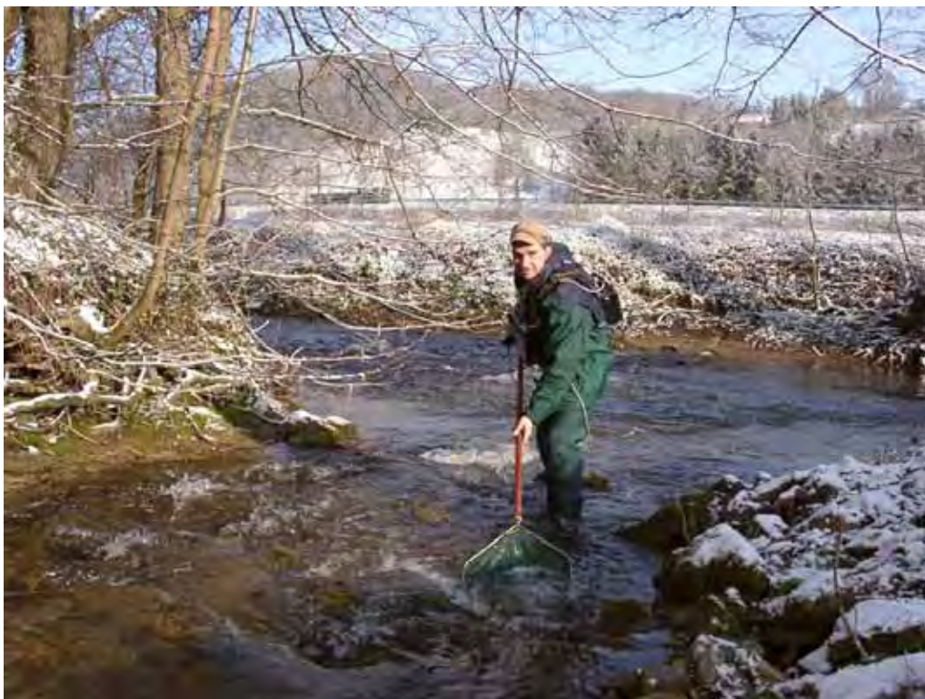
Bild. 7.3-1: Streckenbefischung watend gegen die Strömung mit einem tragbaren Elektrofischgerät
