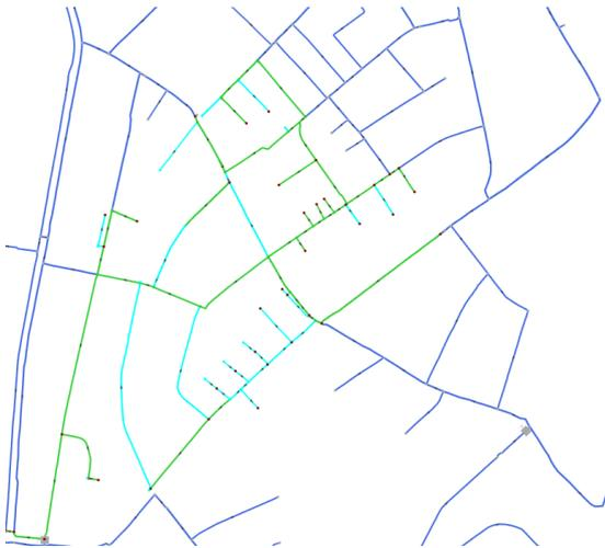
**Abbildung 79: Räumliche Ausdehnung der ermittelten Hochzonen in Stolberg auf Basis realer Geschosshöhen**
