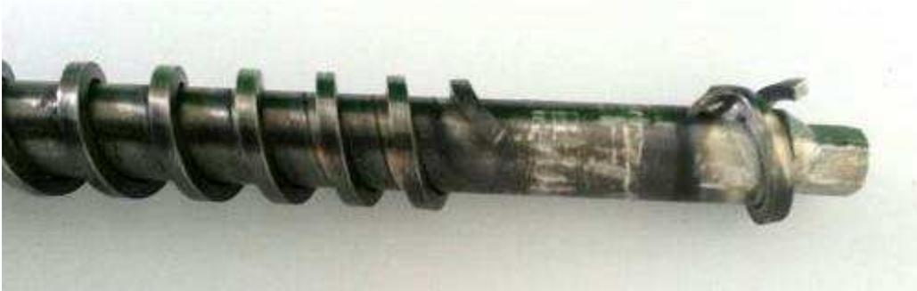
**Bild 4.14: Defekte Dosierschnecke im ausgebauten Zustand**
