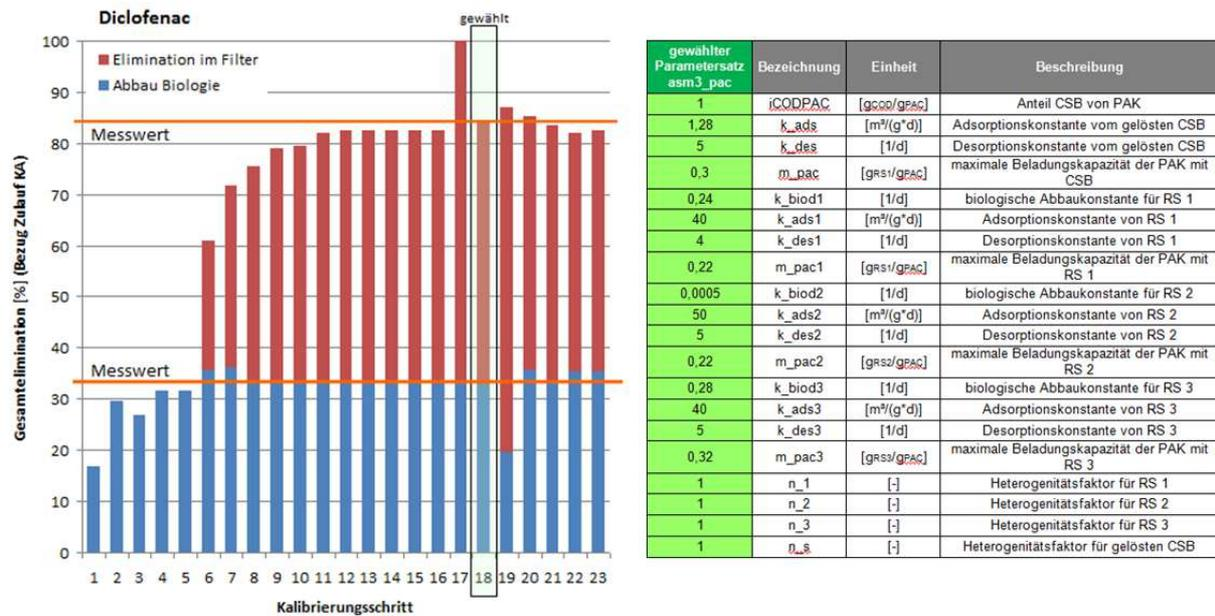
**Bild 4.46: Kalibrierung der Adsorptionsparameter zum Abgleich der Simulationsergebnisse mit den Messwerten der DCF-Elimination**
