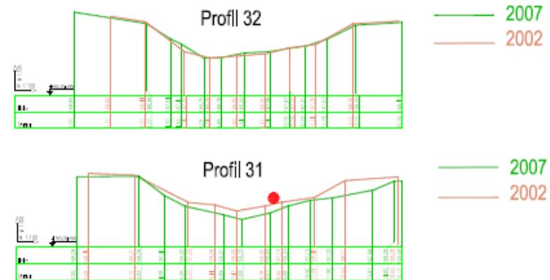
Abb. 2: Querschnitt im Bereich der Profile 31 und 32 im September 2002 vor (braun) und 5 Jahre nach der Maßnahme im Juni 2007 (grün)
