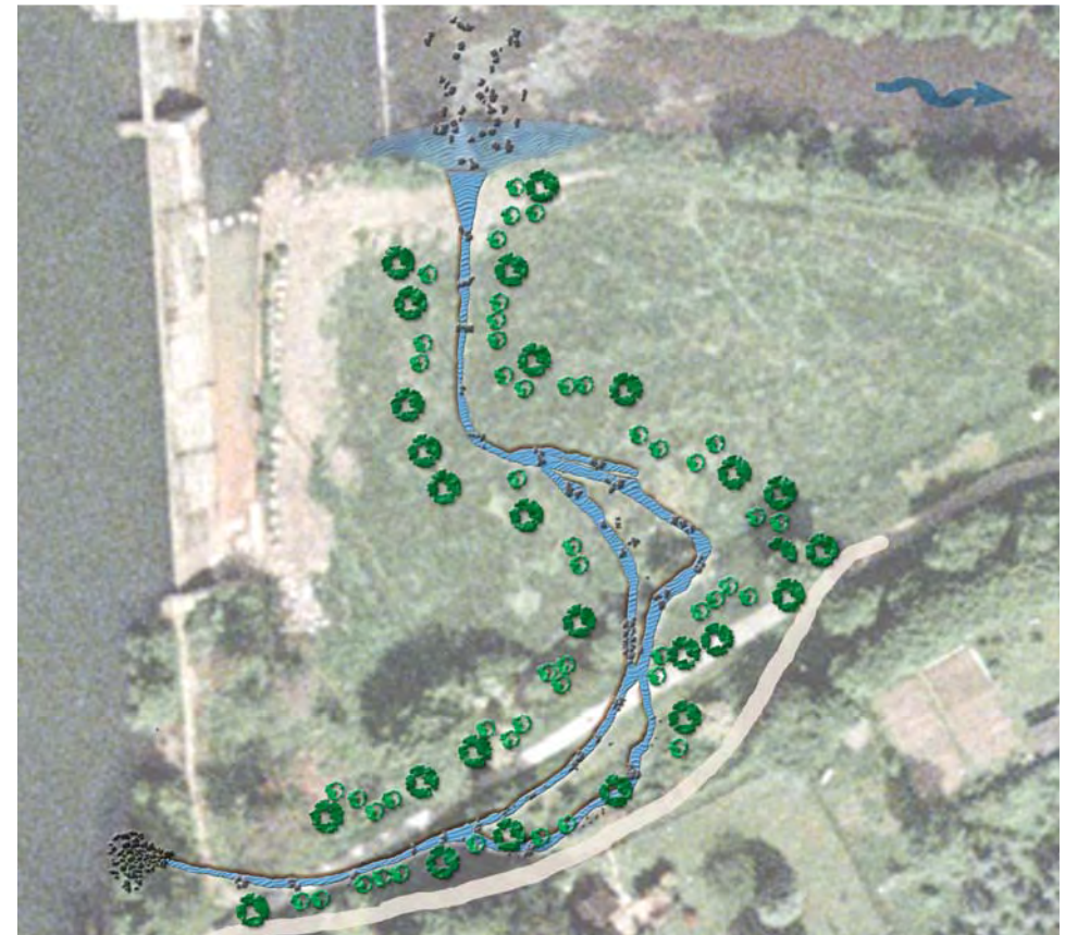
Luftbild vom Absperrbauwerk mit geplantem Fischaufstieg und verlegtem Fußweg
