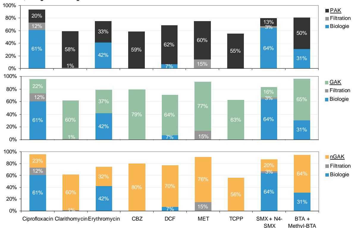
Bild 3.14: Elimination der Spurenstoffe in Bezug auf den Zulauf zur biologischen Stufe
